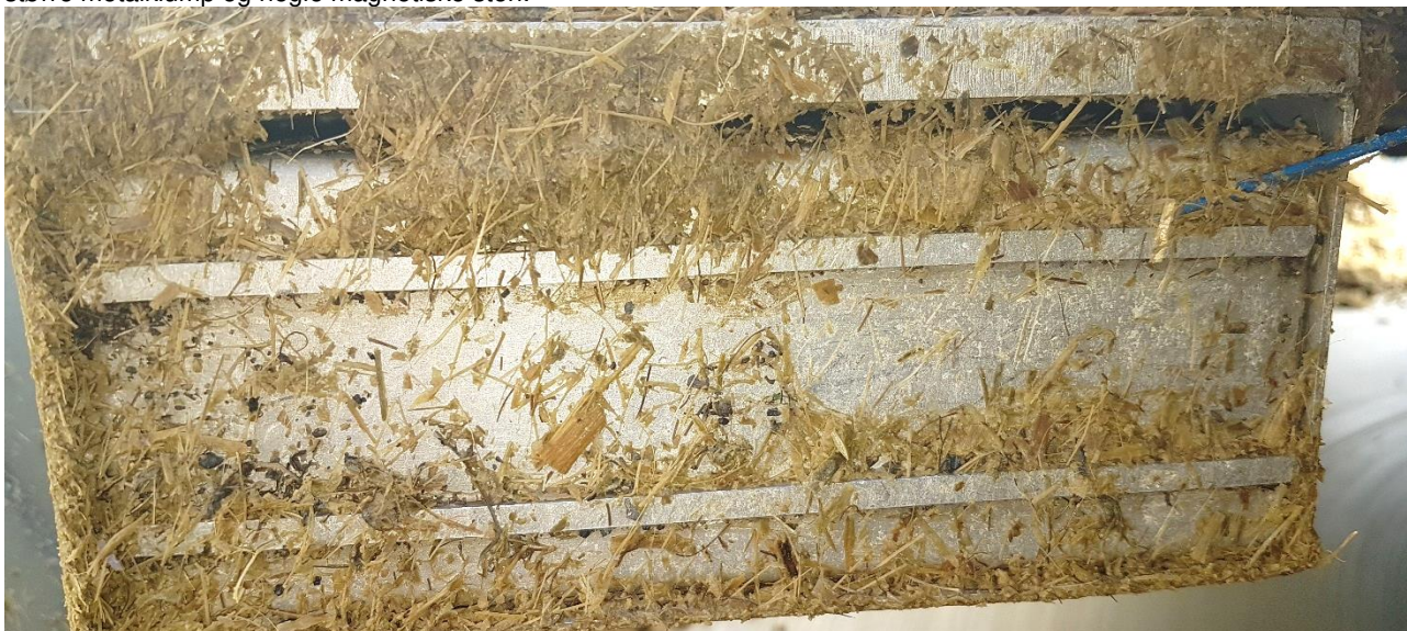
Foto 3. Magnet monteret på knivplade. Foto viser fangst af et stykke spikestråd, men trådstykket er ikke stærkt bundet til magneten. Ud over spikeståltråd er der fanget små metalstykker og nogen tilsmudsning af magneten med ensilage.
