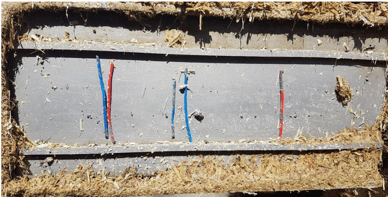
Foto 2. Magnet monteret i toppen af forreste snegl, magneten har vertikal feltretning. Foto viser fangst i test 3, hvor der er fanget 1 stk 45 mm og 2 stk 60 mm blå ståltråd tilsat til test 3 samt 2 stk 60 mm rød ståltråd, som er overført med ensilagen fra test 2. Alle ståltrådsstykker sidder i feltretningen. Ud over spikeståltråd er der fanget små metalstykker, en større metalklump og nogle magnetiske sten.
